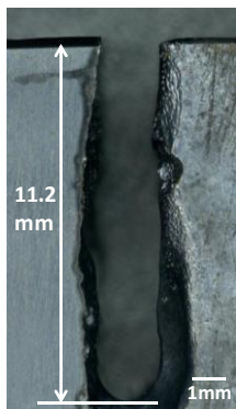
図 5 PE ワイヤによる加工溝形状
