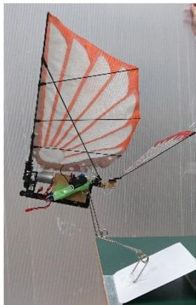
図8. 脚を取り付けた羽ばたき飛行ロボット
