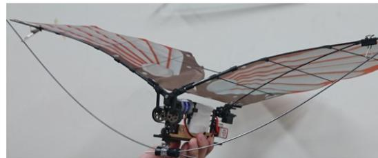
図5. 増力装置を組み込んだ羽ばたき飛行ロボット
