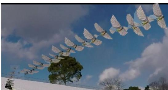
図9. 跳躍による飛び立ちの実現
