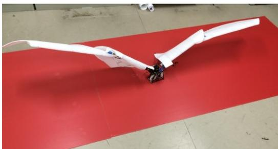
図4. 羽ばたき飛行ロボット
