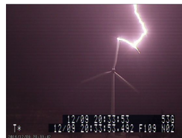
図3 回転翼への落雷の光学観測例 (風力発電運転中)
