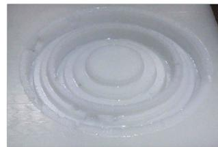
図 5 液晶封入後の様子
