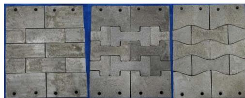
図3 せん断試験の試験体
