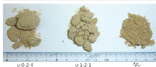
図3 用いた菌株による砂の一軸圧縮強さの違い(上)と、固化後の試料の様子(下)
