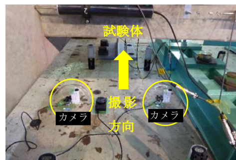
図2 4K ビデオカメラ設置状況（一部）
