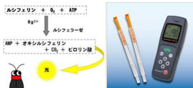
(図1) ATP+AMP 拭き取り検査の原理と検査キット(キッコーマンバイオケミファ(株)HPより)
