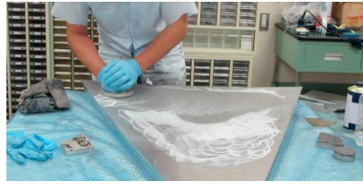
図2. ピッチ盤と研磨剤(酸化アルミニウム、 $3\mu\text{m}$ )を用いた研磨の様子
