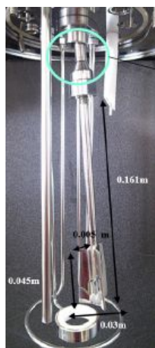
図 7 実験に用いた旋回型攪拌翼
