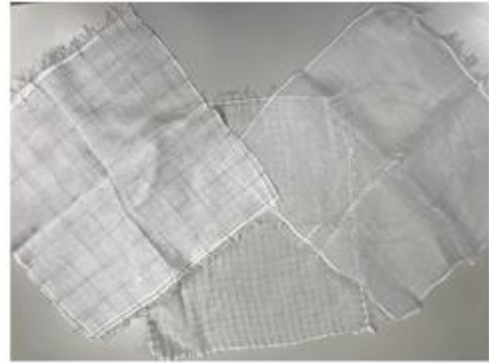
Fig. 1. 電気伝導体を封入した試作ガーゼ
