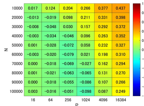
図3: 計算機の一部のリソースを用いたベンチマーク結果に基づく性能予測の精度(実測データと予測結果の誤差を評価)
