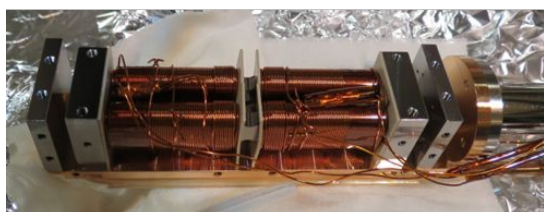
図4：小型電磁石を備えた純鉄製磁気回路
