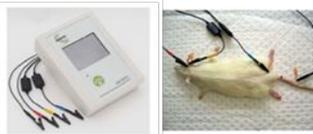
動物用生体電気インピーダンス(BIA)機器(写真)を用いて体液量を測定した(Masuda T et al. Am J Physiol Endocrinol Metab 2014)。
