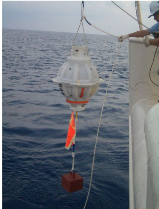
図 1. 室戸沖に投入された圧力計(PIES)
