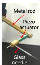
図 3.1 振動系の構成
