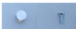
本実験における検知対象落下物の写真(左:標準目標,右:ボルト)
