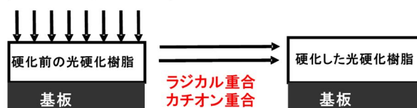
図4。真紫外 LED を用いた光硬化系の概念図。
