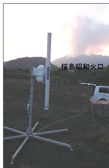
図 2 船舶レーダによる噴煙柱の観測
