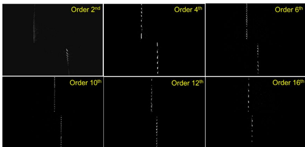
図4 回折次数毎のシングルショット断層イメージ（試料： 100\mu\text{m} 段差表面）。
