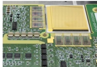
図 2: 125 ミクロンストリップピッチ CdTe 両面ストリップ検出器
