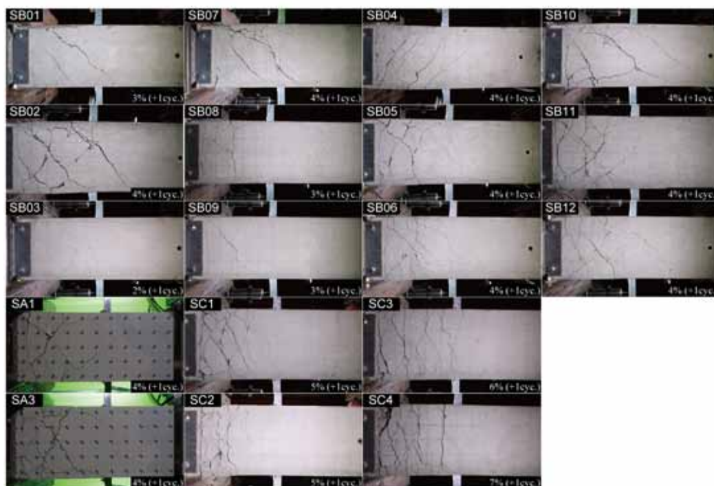
図4 最大せん断力点（正）直後で変位 0mm 時の写真
