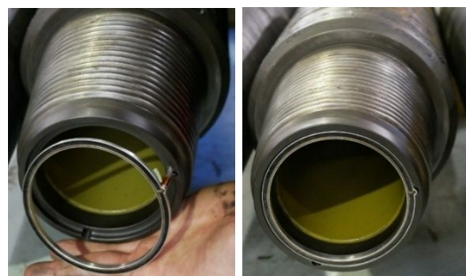
図3. Tool joint の Pin 部に設けたガンドリル加工へのコイル装着 4)
