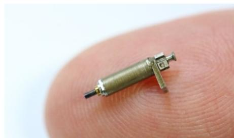
図5 マイクロ遊星歯車を取り付けたマイクロギアードモータ
