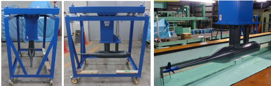
図1 製作した実海域再現水槽用プロペラ単独試験機（左：正面、中央：側面、右：実海域再現水槽台車ターンテーブル搭載時）
