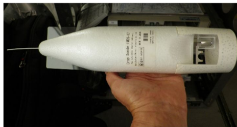
図4：名古屋大学と明星電気で新しく開発したドロップゾンデ本体。
