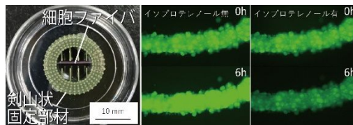
図 8. 剣山状固定部材を用いた細胞ファイバの固定およびイソプレテレンールの添加時の遊離脂肪酸放出の観察。
