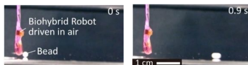
図5. 空中で駆動可能なバイオアクチュエータによるビーズの操作。
