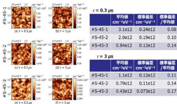
図 2 局所 DLTS による  $\text{SiO}_2/\text{SiC}$  界面の界面準位密度分布の定量測定例 (上から順にポスト処理無/窒化処理 10 min./窒化処理 60 min. の試料評価結果)
