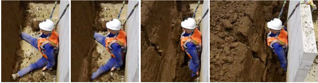
写真2 崩壊した土砂が保護具を装着した人型供試体に衝突する様子
