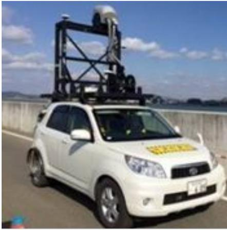
MMS は、車両に GNSS 受信機、慣性計測装置 (IMU : Inertial Measurement Unit), レーザスキャナなどの計測機器を搭載し、自己位置と姿勢を測定しながら車両周辺の三次元形状を計測できる車載レーザ計測システムである。その自己位置精度は、RTK-GNSS 測位結果と IMU の慣性測位結果の結合処理により決定される。一般に RTK-GNSS 測位は、固定局から MMS までの距離 (基線長) が長くなるにつれて、GNSS 電波の電離層遅延などの影響により位置精度が劣化する。長い線状構造物の河川堤防では、基線長が長くなりやすいため、MMS 取得データの
