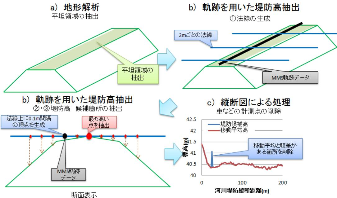
上図は、本研究で開発した MMS 計測から堤防高を抽出する処理を示すものであるが、本手法は、MMS 計測により得られる軌跡データと MMS 点群を用いる。その処理は、3つの工程で構成され、はじめに、MMS 点群を用いた地形解析を行い、天端の平坦領域を抽出する。その結果と軌跡データを用いて、堤防高の候補となる箇所を抽出する。最後に、縦断方向の連続性に着目した処理を施し、堤防高を抽出する。
