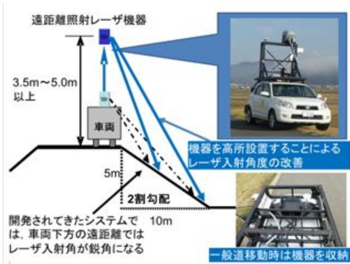
てきたため ( Mobile Mapping System: モービルマッピングシステムとも称する ), 天端から法面といった遠距離に照射されるレーザーの入射角度は鋭角的になることで, フットプリントと言われるレーザーの照射範囲が大きくなり, 高精度化が困難である. この課題に対して図のように高い位置からのレーザー照射が有効であるが, 走行中の車両は上下の揺動が激しく, 高所設置機器の姿勢計測
