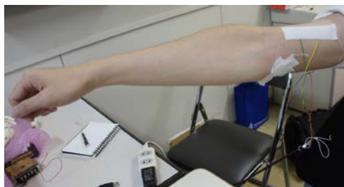
図 13(a) 健常者の肘に貼った筋電センサ
