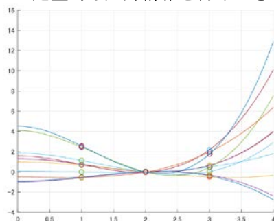
図 10 各センサ（センサ 1~3）の配置に対応した皮膚センサ信号変化
