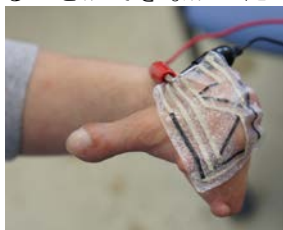
図 1 (a) 上肢欠損者に装着した膜面皮膚センサシート 図 1 (b) 皮膚変形の計測検証
