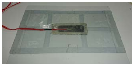
図 3(a) 基材に貼った皮膚センサシート 図 3(b) 評価用治具システム（全体）
