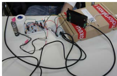
図 13(b) 試作した筋電センサ計測制御回路
