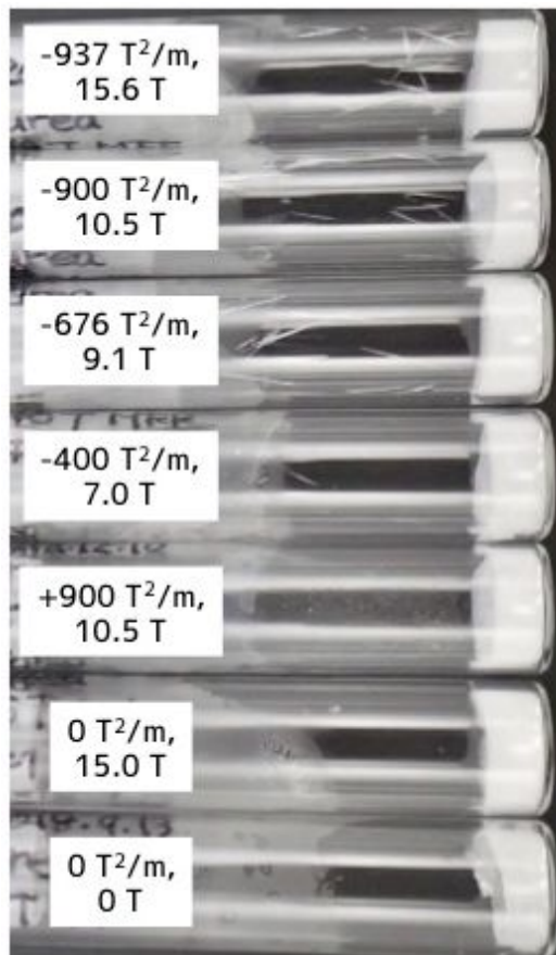
Fig. 5 様々な磁場及び磁気力の条件で凝固した尿素の写真。
