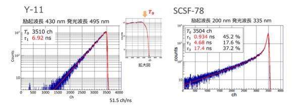
上図は WLS ファイバーY11 及びシンチレーションファイバーSCSF-78 の測定結果である。これらをはじめとしてすべての試料について、< 1ns の速い発光も含めて蛍光寿命とその成分比を決定することができた。将来計画の R&D においては、真空紫外光による測定、低温や高温下での測定、放射線照射による劣化材料の測定なども求められるが、本研究でシンチレーター材料の時間特性の性能評価の手法を確立することができたといえる。
