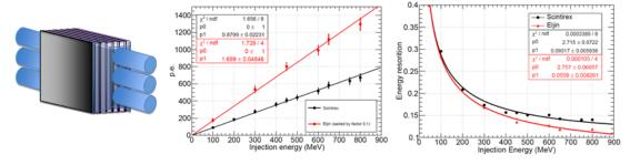
上中図が獲得光電子数換算したエネルギー応答,上右図がエネルギー分解能の測定結果である。(黒がシンチレックス,赤が EJ200)入射エネルギーに対する応答の直線性やエネルギー分解能については,良好な性能を有することが確認できた。獲得光電子数はシンチレックスが 0.88 pe/MeV, EJ200 が 17 pe/MeV であった。またエネルギー分解能については,シンチレックスが統計項 8.6%,定数項 9.3%, EJ200 が統計項 8.7%,定数項 5.6%であった。
