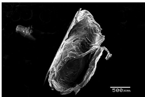
図 2 産業廃棄物焼却灰から析出した鉄の単体の SEM 像。
