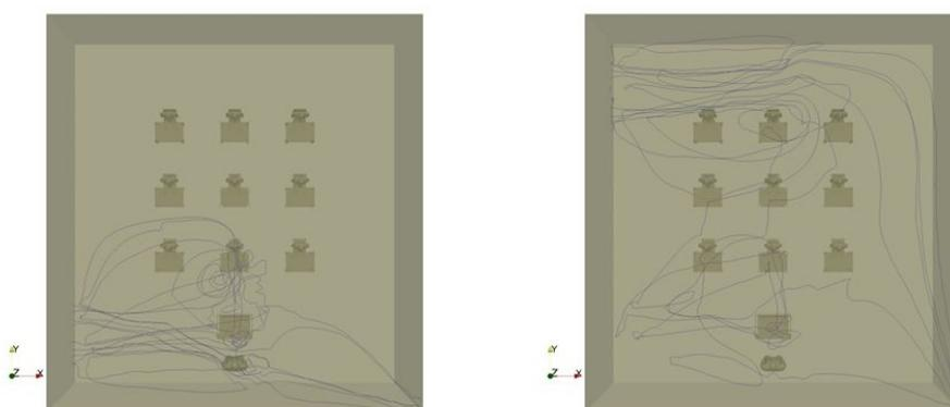
図5 各換気口からの流入エアの様子(左:前方からの流入,右:後方からの流入)
