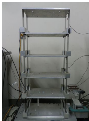
図5 多自由度(5層構造)実験装置
