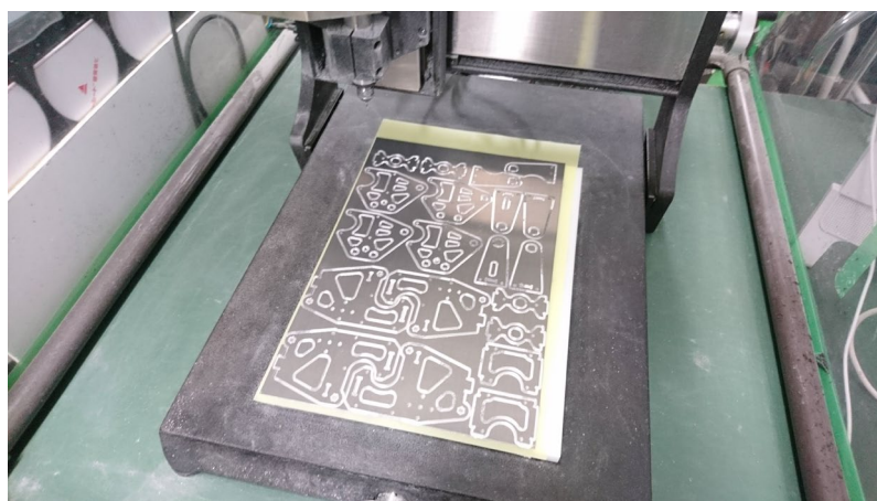
図 3 公開されたデータに基づき卓上 CNC で部品を切削している様子
