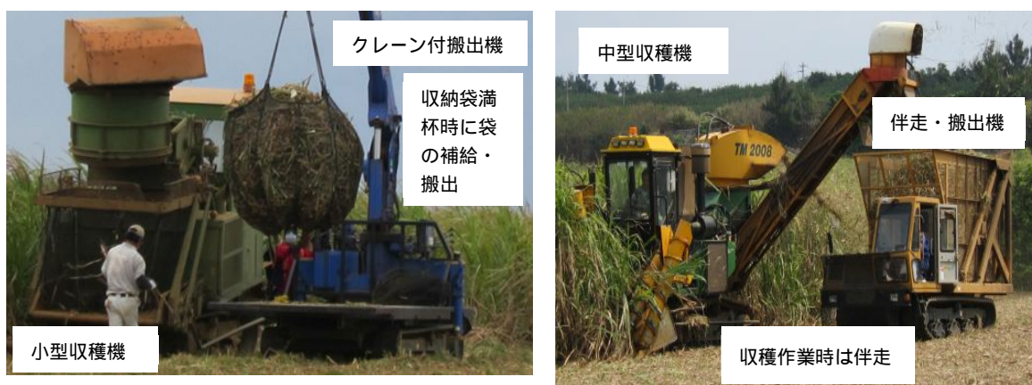
図3 収穫機と搬出機の連携による収穫作業
