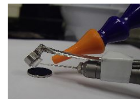
図 2. ミストアシスト Er:YAG-PLD 法
