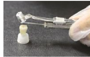
図 1 開発した Er:YAG-PLD ユニット
