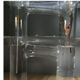
図1. 電気化学的な方法で試料に有機分子を導入している様子。右側は試料のSnSe<sub>2</sub>であり、左側は対電極(Pt)であり、両者とも溶液につけている。溶液はヘキシルアミンをDMSOに溶かしたものである。
