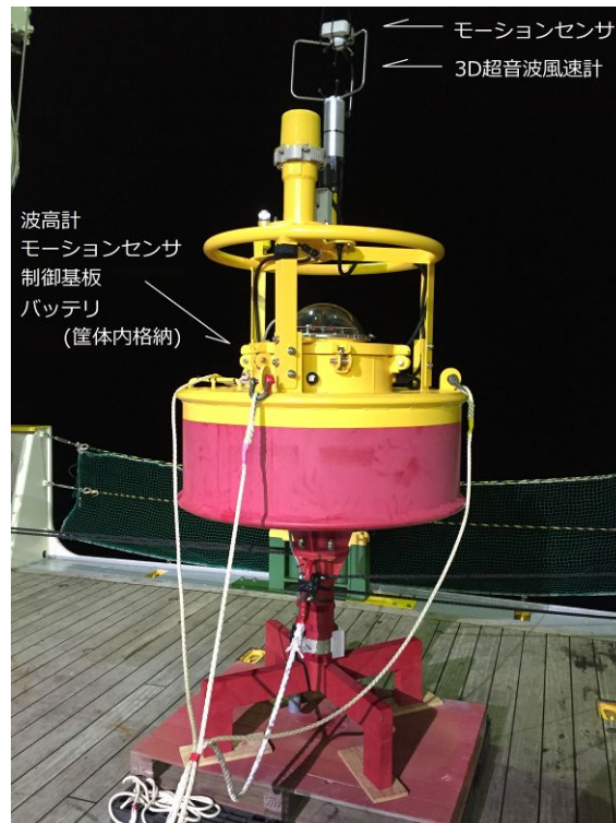
図 2. (上) 大槌湾に係留された風・波浪モニタリングブイ
