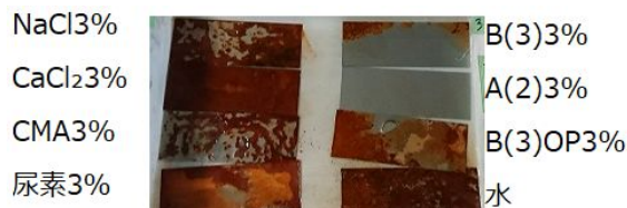
図 6 腐食生成の様子 (7 日目)
