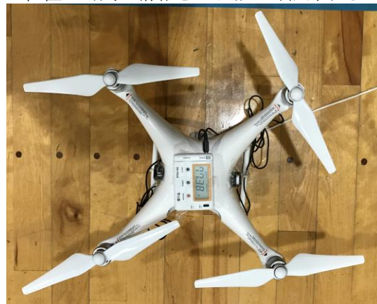
図1 側面に照度センサーを2つ装着し、上面にデータロガーを取り付けたマルチコプター(PHANTOM4、DJI社)の様子
