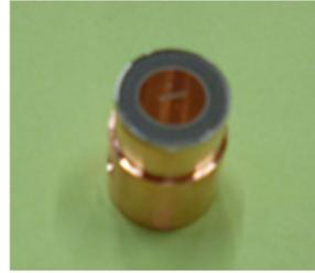
図7 スリット加工サファイア膜
