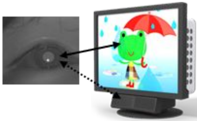
図1:Gazefinderの概要。機器内部からの近赤外線によって生ずる角膜反射の位置をカメラがとらえると(点線矢印)、画面上の注視点(実線矢印)を座標として自動計測ができる(Ebisawaら、2013)。
