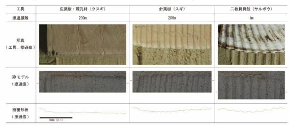
図 実験試料による擦過痕の三次元計測と断面形状
