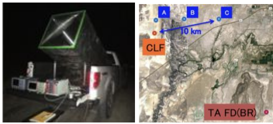
図 2. (左)CRAFFT 望遠鏡試作機による試験観測の様子。(右) 試験観測地点 A、B、C と、TA 実験の望遠鏡サイト(BR) 及び CLF の配置図。
