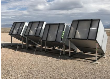
図 6. TA FD BRM サイトにて、CRAFFT 望遠鏡 4 台を設置した様子。
