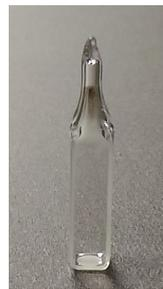
図1. セシウム封入ガラスセル
