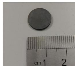
図3. 直径13mmのフェライト磁石
