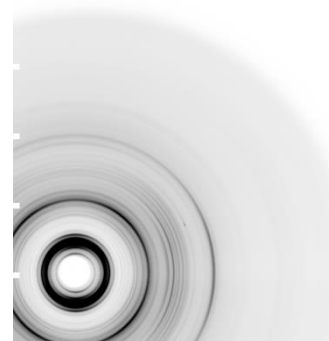
図 3. 配向を示す C1-PEA の X 線写真図。
