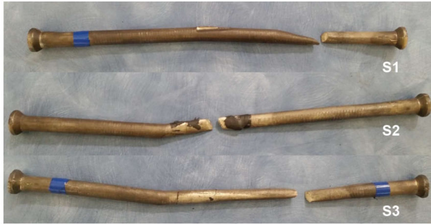
図4：引張試験後の破断性情
